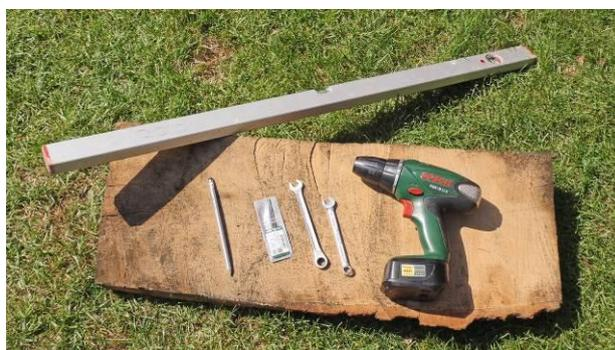
Necesitarás un **taladrador** con una **broca de 4,2 mm** y un **destornillador Phillips** (PH2). También necesitarás un **nivel de burbuja**, un **flexómetro**, un **lápiz** para marcar y dos **llaves de horquilla nr. 10**.
